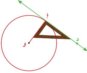
المماس عمودي على نصف قطر التماس إذا كان مستقيم مماس لدائرة فإنه يكون متعامدا مع نصف القطر المار بنقطة التماس أي أن  $\overline{پو} \perp \overline{أج}$
