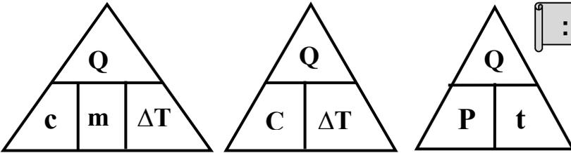
\*\* لحساب الطاقة الحرارية بدلالة السعة الحرارية النوعية نستخدم العلاقة  $Q = c m \Delta T$
