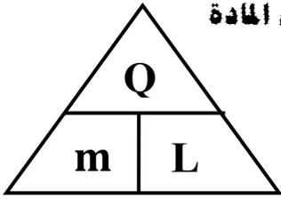
\*\* لحساب الحرارة الكامنة للمادة نستخدم العلاقة  $L = \frac{Q}{m}$
