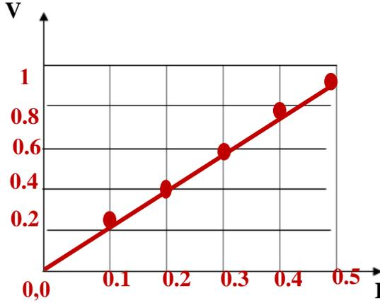
(ب) أحسب المقاومة الكهربائية للسلك :
