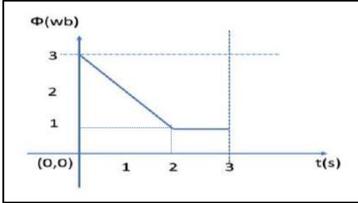
مسئنا بالشكل الموجود امامك فإن أحد الأشكال التالية الموجودة في الأسفل تمثل القوة الدافعة الكهربائية المتولدة في الملف
