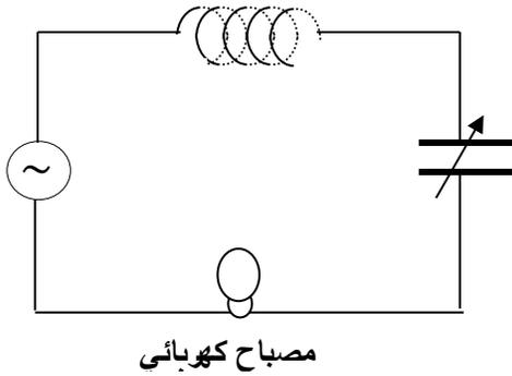
4- في الشكل المقابل مصباح كهربائي مقاومته  $\Omega (400)$  يتصل على التوالي مع ملف حثي نقي معامل حثه الذاتي  $H (1)$  ومكثف ممانعته السعوية  $\Omega (224)$  ومولد للتيار المتردد فرق جهده الفعال  $V (220)$  وتردده  $Hz (200 / \pi)$  , احسب :
