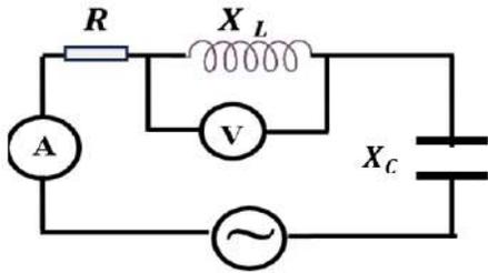
4- الدائرة الكهربائية المبينة في الشكل المقابل تتكون من ملف حثي نقي معامل حثه الذاتي  $H (0.2)$  ومقاومته الأومية  $\Omega (20)$  ومكثف مستو سعته  $F (2 \times 10^{-4})$  ومصدر تيار متردد فرق جهده الفعال  $V (100)$  وتردده  $Hz (100 / \pi)$  . احسب :
