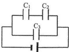
وصلت ثلاث مكثفات  $C_3 = (2) \mu.F$ ,  $C_2 = (12) \mu.F$ ,  $C_1 = (4) \mu.F$  بمصدر جهد مستمر  $V = (10)$  كما موضح بالشكل. احسب:
