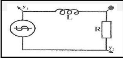
الشكل المقابل يوضح دائرة تيار متردد تتكون من مصدر تيار متردد يتصل على التوالي بملف حثي نقي ممانعته الحثية  $\Omega (40)$  ومقاومة صرفة  $\Omega (10)$  يمر به تيار لحظي يتمثل في العلاقة :  $i_t = 10 \sin (100 \pi . t)$  . احسب :
