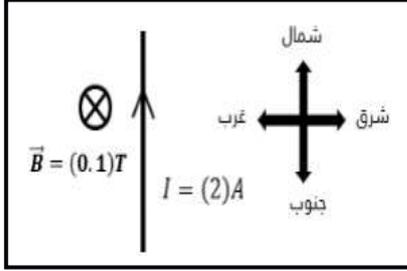
2- ( ) الشكل المجاور يوضح سلك مستقيم طوله  $m$  ( 0.3 ) موضوع عمودياً في مجال مغناطيسي منتظم شدته  $T$  ( 0.1 ) ويمر به تيار شدته  $A$  ( 2 ) فإن القوة الكهرومغناطيسية المؤثرة على السلك تساوي  $N$  ( 0.06 ) في اتجاه الغرب .
