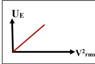
الطاقة الكهربائية المخزنة
