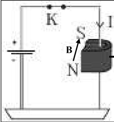
مثال 2 : مجال مغناطيسي منتظم مقداره ( 0.4 T ) موضوع فيه سلك مستقيم طوله ( 10 cm ) يسري فيه تيار كهربائي شدته ( 2 A ) عمودي علي اتجاه المجال المغناطيسي كما بالشكل المقابل .
