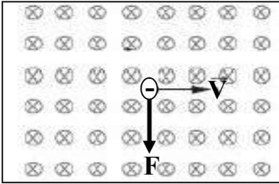
مثال 1 : مجال مغناطيسي منتظم ( 0.2 T ) واتجاهه عمودي داخل الورقة دخل هذا المجال جسم مشحون بشحنة مقدارها (  $- 2 \mu\text{c}$  ) وبسرعة ( 200 m/s ) .
