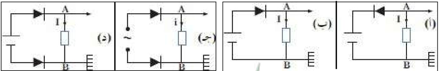
يعمل في الشكل ( ب ) لأن التيار المار هو تيار انحياز أمامي
