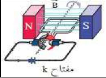
مبدأ عمل المحرك الكهربائي :
