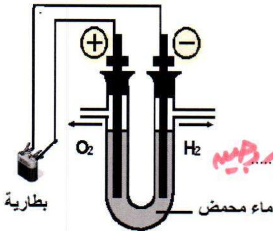
الرسم يوضح تجربة التحليل الكهربى للماء ادرسه جيدا ثم اجب عما يلي :
