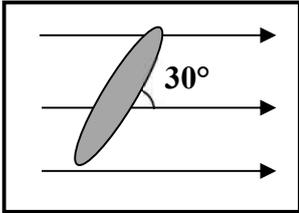
2- وضعت حلقة معدنية مساحتها ( A ) تميل بزاوية (  $30^\circ$  ) على اتجاه مجال مغناطيسي شدته ( B ) كما في الشكل فإن التدفق المغناطيسي الذي يجتاز الحلقة يساوي :
