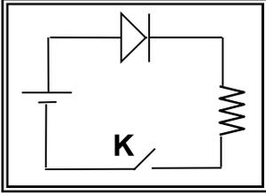
(أ) اشرح بإيجاز سبب مرور التيار الكهربائي في الدائرة الموضحة بالشكل بعد غلق المفتاح K
