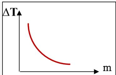
فرق درجات الحرارة وكتلة المادة عند ثبات الطاقة الحرارية المكتسبة أو المفقودة
