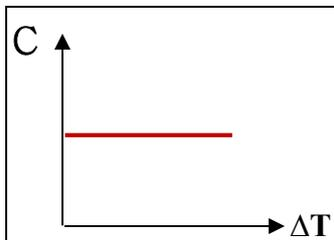
السعة الحرارية وفرق درجات الحرارة عند ثبات كتلة المادة
