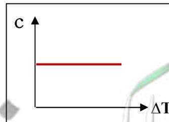
السعة الحرارية النوعية وفرق درجات الحرارة لنفس المادة
