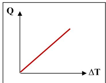
الطاقة الحرارية المكتسبة أو المفقودة وفرق درجات الحرارة عند ثبات باقي العوامل
