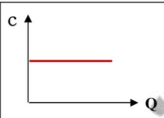
السعة الحرارية النوعية والطاقة الحرارية لنفس المادة
