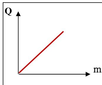
الطاقة الحرارية المكتسبة أو المفقودة وكتلة المادة عند ثبات باقي العوامل
