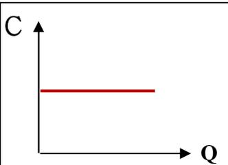
السعة الحرارية والطاقة الحرارية عند ثبات كتلة المادة
