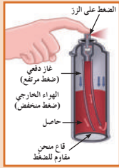
شكل (8) الفرق في الضغط بين داخل عبوة رذاذ الدهان والهواء الخارجي هو أساس آلية عمل مثل هذه العبوات. كيف يكون الضغط داخل العبوة عندما لا تتسكّن المادة المستخدمة في الدهان من التناثر والخروج منها؟
