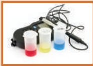
شكل (64) جهاز قياس الرقم الهيدروجيني مع محاليل منقطة لمعايرة الجهاز
