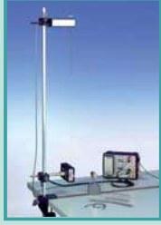
(شكل 31) جهاز السقوط الحرّ مثبت عليه مؤشر عماد السرعة، ويتمّ تسجيل السرعة اللحظية أثناء السقوط الحرّ مع الزمن.
