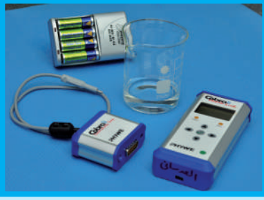
شكل (24) جهاز لقياس درجة التأين في المحلول.
