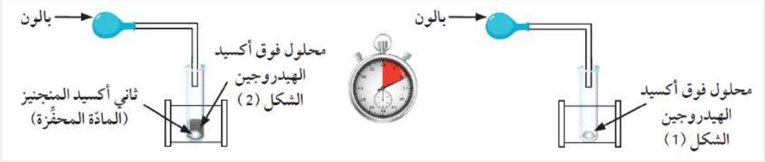
ضع محلول فوق أكسيد الهيدروجين في أنبوبة الاختبار ، الشكل (1) وضع قليلا من ثاني أكسيد المنجنيز (المادة المحفزة) ثم أضف إليها محلول فوق أكسيد الهيدروجين في أنبوبة الاختبار ، الشكل (2) ، وقارن الزمن المستغرق لحدوث التفاعل الكيميائي فيها.
