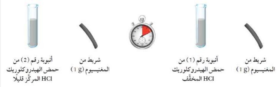
ضع قطعة من شريط المغنيسيوم (Mg) في أنبوبة الاختبار رقم (1) ثم ضع قطعة من شريط المغنيسيوم في أنبوبة الاختبار رقم (2)، وقارن الزمن المستغرق لحدوث التفاعل الكيميائي
