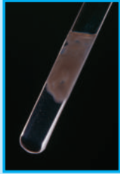
شكل (9) ترسيب كلوريد الفضة من خلال تفاعل كلوريد الصوديوم مع نترات الفضة
